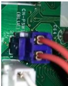
CN-PSW: hoge druk schakelaar aansluiting op de print
